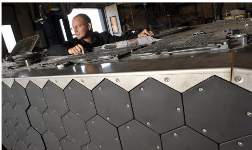
Boční stěna vozidla CV-90 pokrytá souvislou vrstvou termopixelů
