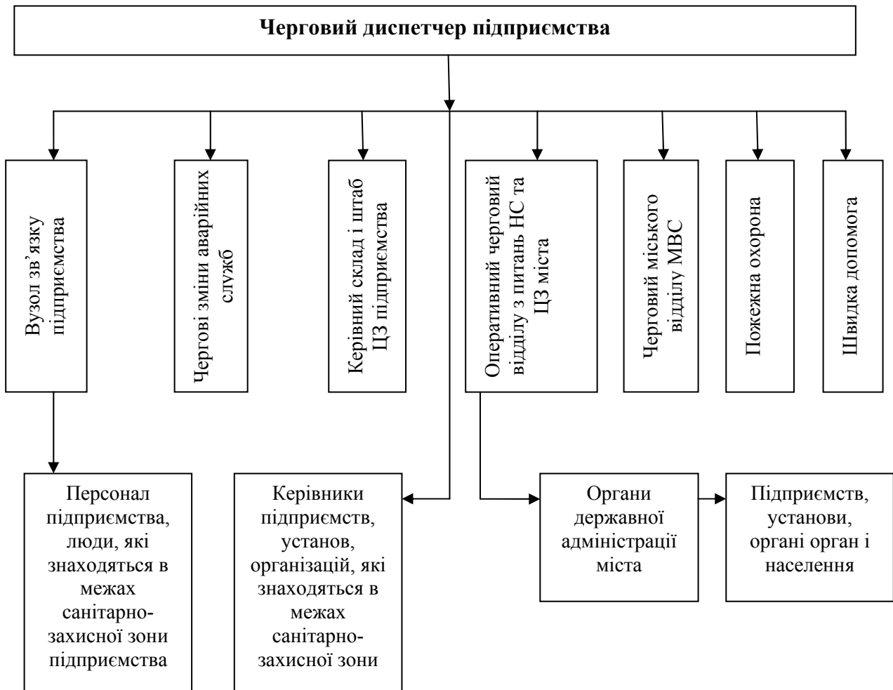
Рис. 1. Схема оповіщення персоналу підприємства, керівників підприємств, установ, організацій і населення, які потрапляють в зону хімічного зараження
